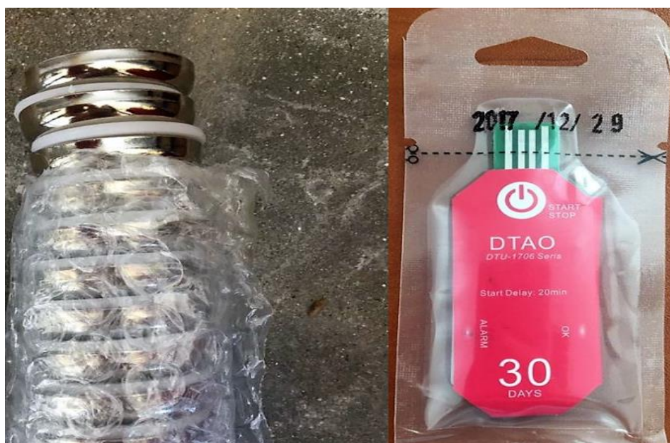
Rysunek 5.1. Magnesy do mocowania pianki PUR oraz czujnik rejestrujący temperaturę wewnątrz kontenera
