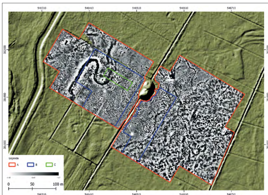
Ryc. 3a. Rozprza. Wizualizacje wyników badań magnetycznych na podkładzie cieniowanego Numerycznego Modelu Terenu. Oprac. P. Wroniecki. A. Zasięg pomiarów magnetycznych; B. Zasięg pomiarów elektrooporowych; C. Zasięg pomiarów georadarowych.
