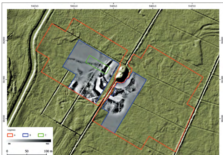
Ryc. 3b. Rozprza. Wizualizacje wyników badań elektrooporowych na podkładzie cieniowanego Numerycznego Modelu Terenu. Oprac. P. Wroniecki. A. Zasięg pomiarów magnetycznych; B. Zasięg pomiarów elektrooporowych; C. Zasięg pomiarów georadarowych.
