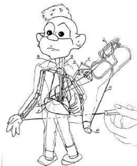
Il. 17. Konstrukcja lalki nadgarstkowej Władimira Zakharowa
