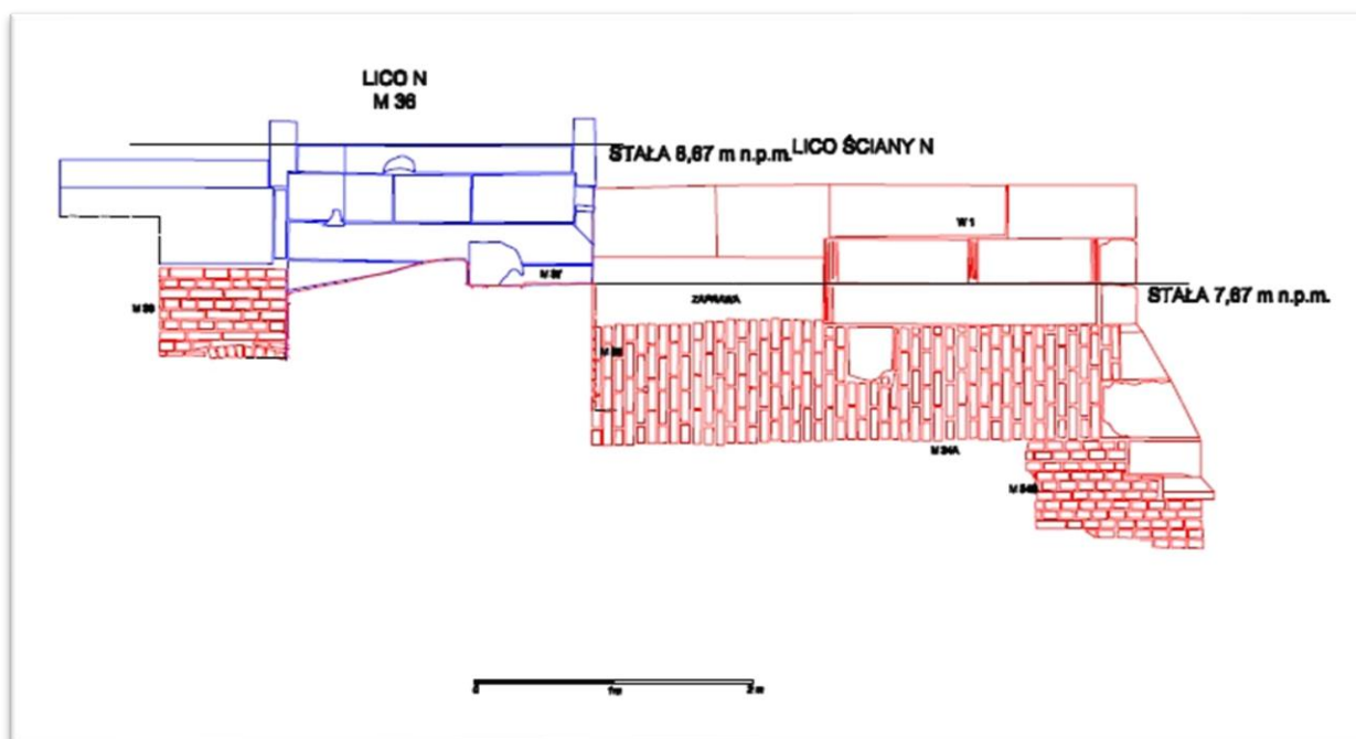
Ryc.4.40 Sondaż 1 z 2010 roku. Widok na dolną część kamiennej elewacji północnej wraz z oskarpowaniem oraz fundament pilastru przejazdu wybitego w wale ustawiony na ceglany fundament oraz kamienny próg w przejeździe wsparty również na ceglany fundament (rys. D. Dyduch, oprac. M. Kasprzak)
