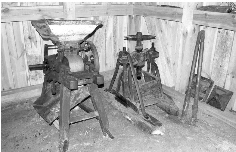
Ryc. 2. Urządzenia technologiczne olejarni: mlewnik walcowy i prasa typu śrubowego. Stan po renowacji na ekspozycji w „Łęczyckiej Zagrodzie Chłopskiej”. Fot. P. Czepas
