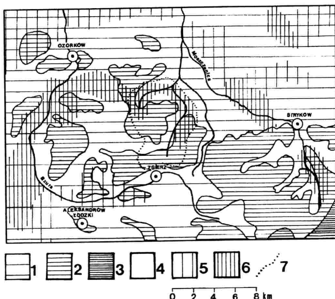
Rys. 5. Głębokość pierwszego poziomu wodonośnego i przepuszczalność utworów powierzchniowych (oprac. na podstawie: Mapa hydrogeologiczna Polski 1:200 000 , arkusz Łódź): ◆ Głębokość poziomu wodonośnego: 1 – 0,0–5,0 m; 2 – 5,0–20,0 m; 3 – 20,0 m i więcej; ◆ Przepuszczalność utworów powierzchniowych: 4 – osady przepuszczalne; 5 – osady słabo przepuszczalne; 6 – osady bardzo słabo przepuszczalne; 7 – dział wodny zlewni badawczej
