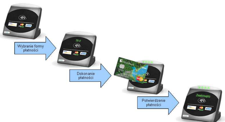
Rysunek 1. Schemat działania kart zbliżeniowych
